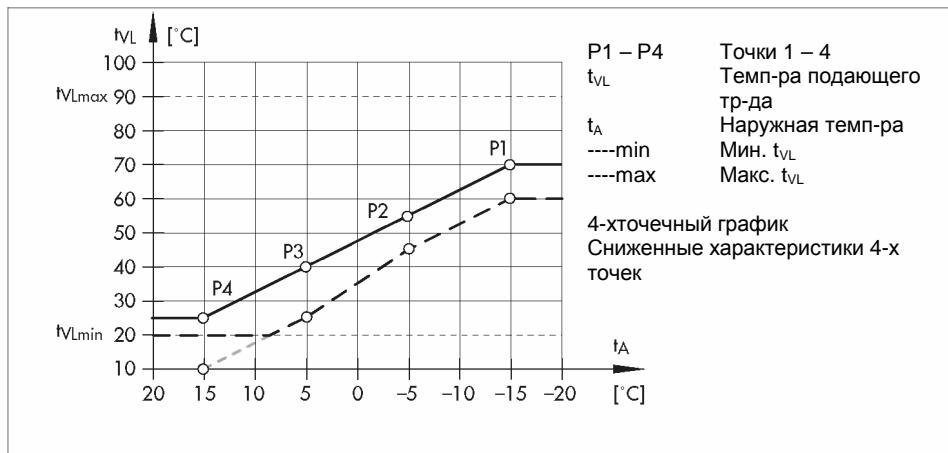
4-хточечный график позволяет вам задать собственные характеристики отопления. Задаются 4 точки для Наружной температуры, Температуры подающего трубопровода, Сниженной температуры подающего трубопровода и Температуры обратного трубопровода. Параметры Максимальной температуры подающего трубопровода и Минимальной температуры подающего трубопровода определяют верхнюю и нижнюю границу регулирования температуры подающего трубопровода.
