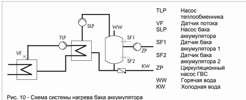
Рис. 10 - Схема системы нагрева бака аккумулятора
