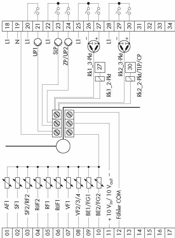
Рис. 14 – Подключение регулятора TROVIS 5573
