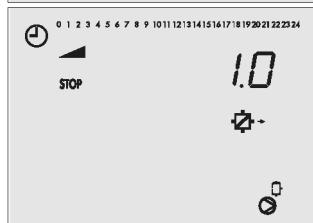
Запаздывание насоса бака аккумулятора
