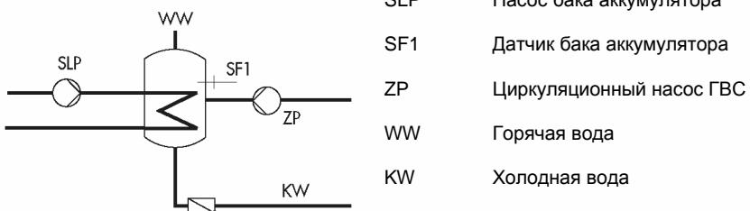
Рис. 8 – Схема системы с баком аккумулятором
