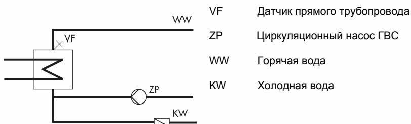
Рис. 11 – Схема системы прямого нагрева ГВС
