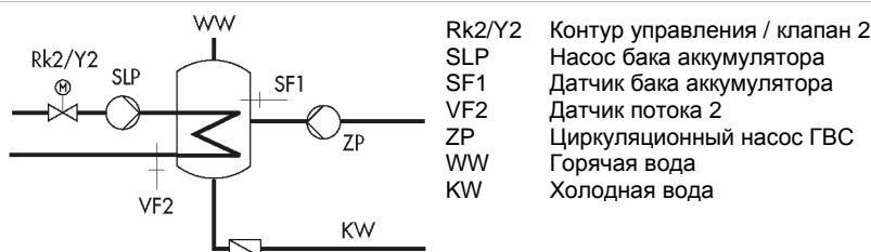
Рис. 9 – Схема системы с баком аккумулятором с проходным клапаном для ограничения температуры обратки.
